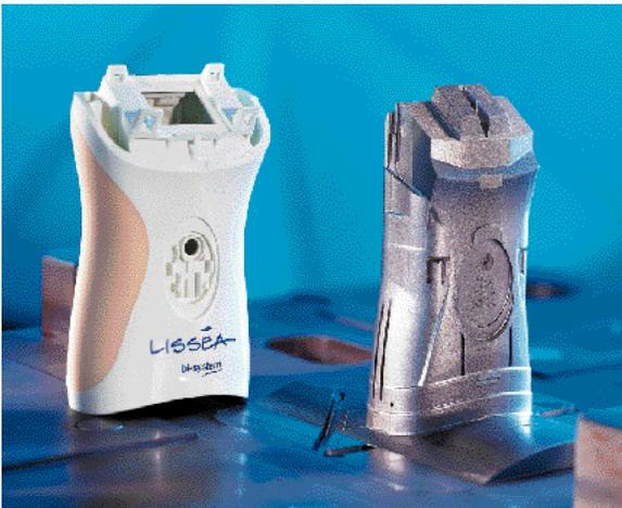
Die Form eines Gehäuses für Rasierapparate zeigt eine Anwendung von Böhler Kunststoffformenstahl.
