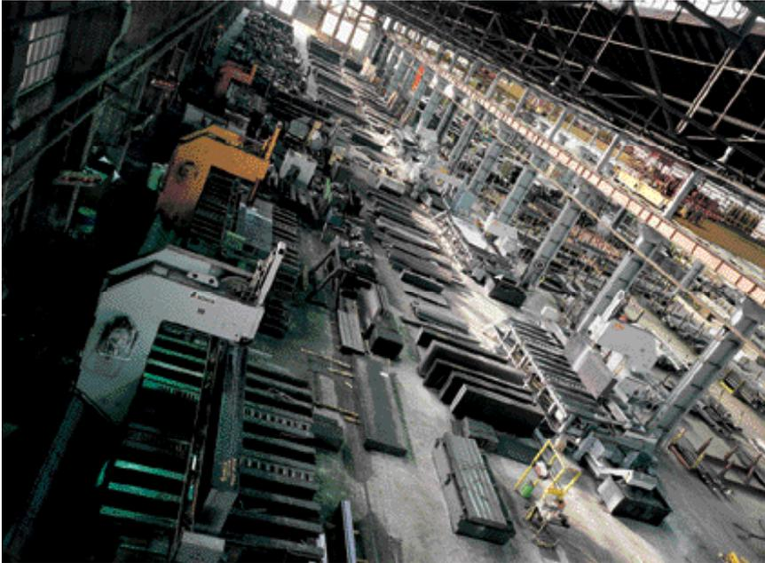
Im Versand werden die Stahlblöcke nach Kundenwunsch gesägt, gefräst und nochmals kontrolliert, bevor sie zur Auslieferung gelangen.
