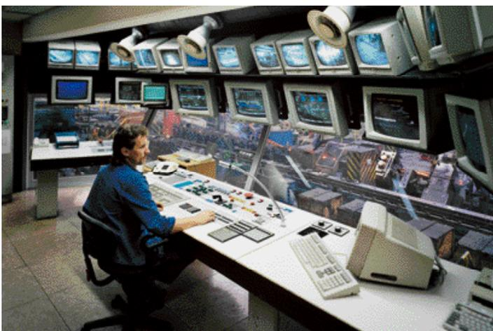
**Das Anforderungsprofil an einen Arbeiter im Walzbetrieb heute. Von klimatisierten Steuerständen aus nimmt der Fachmann Einfluss auf etliche Parameter des Fertigungsprozesses.**
