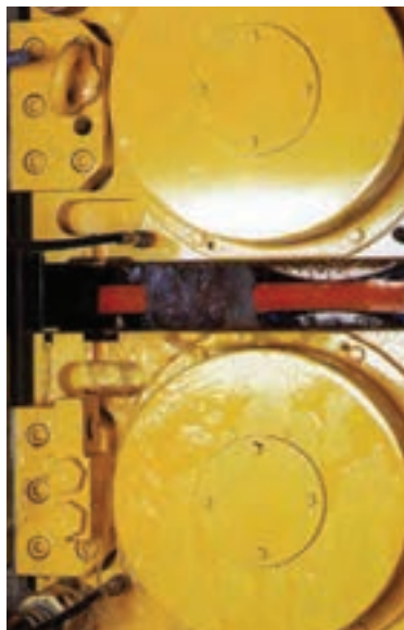
links unten: Mehrlinienwalzwerk. Auf der „Drahtstraße“ wird Edelstahldraht in Form ge- bracht (rund, quadratisch und vierkantig; unterschiedliche Durchmesser).
