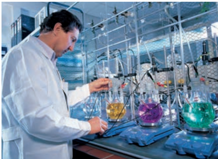
Das Bild zeigt wie in der Entwicklung befindliche Stahlsorten auf Rostbeständigkeit geprüft werden (Korrosionstest).
