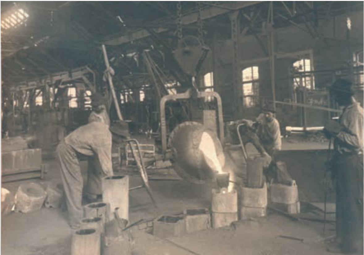
Das Originalfoto aus dem Jahre 1913 zeigt einen Abguss im Tiegelstahlwerk.
