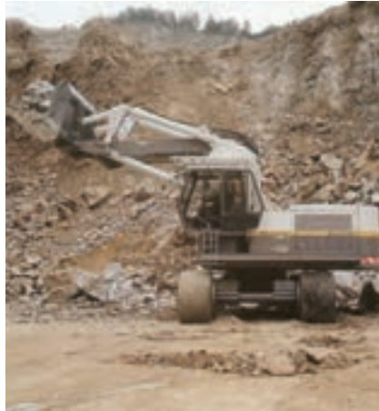
Tieflochbohrgeräte über Tag (ganz links) und unter Tag (unten) sowie ein Böhler Schaufelbagger mit etwa 5 Kubikmeter Schaufelinhalt. Quelle: BBG Baugeräte GmbH
