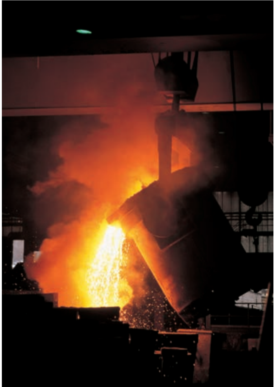
Der Abgussvorgang im Stahlwerk. Die „Stahlsuppe“ hat eine Temperatur von ca. 1600° C.
